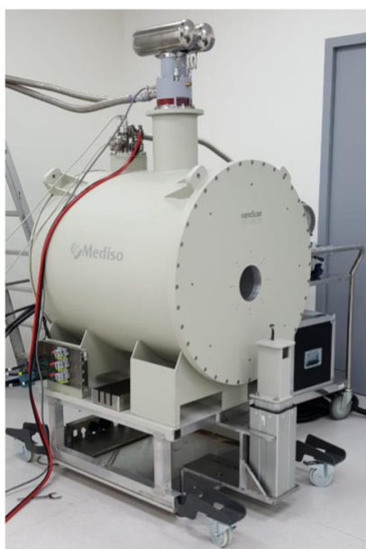
Az első 7T-s MRI berendezés, a kísérleti MRI kompatibilis PET modulok valamint a rólunk kapott első kép
